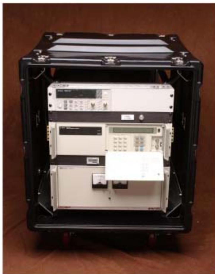
写真2.超高精度の可搬型セシウム原子周波数・時間標準 HP/Agilent/Symmetricon 5071A/001 全世界の周波数・時間標準機関及び研究所 並びに国家標準で使用されている標準器
