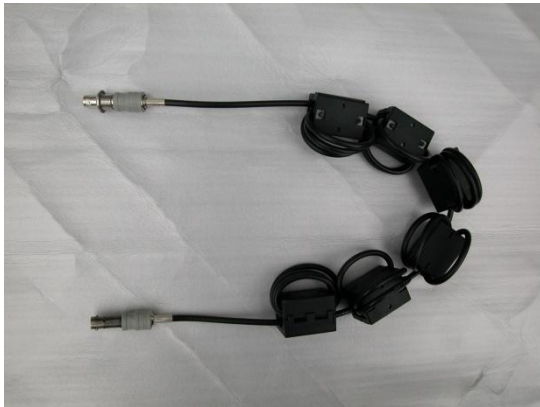
図 8 同軸コモンモードフィルタ
