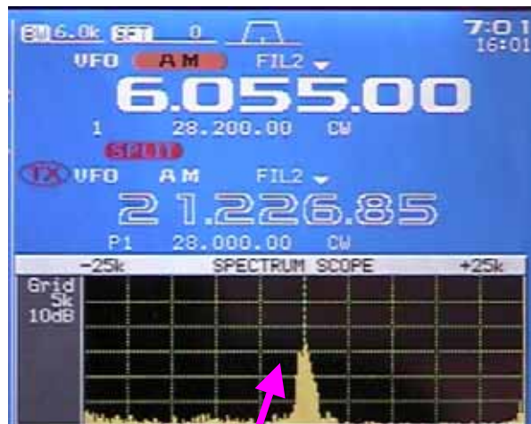
(1) PLC無接続状態
