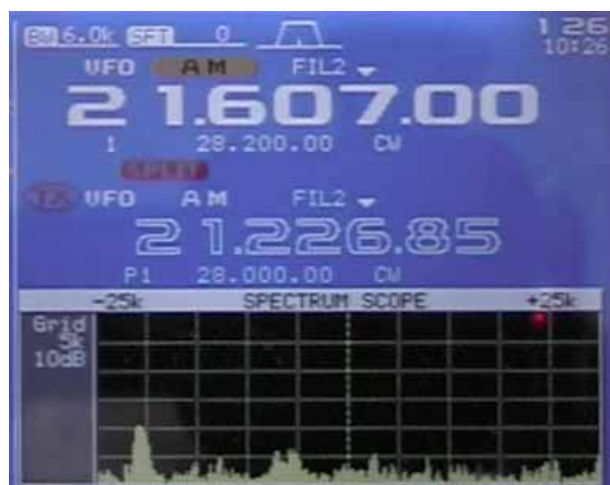
(1) PLC無接続状態
