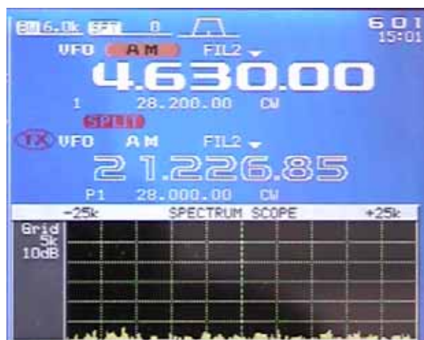
(1) PLC無接続状態
