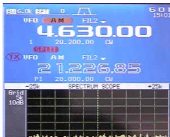
(1)PLC無接続状態
