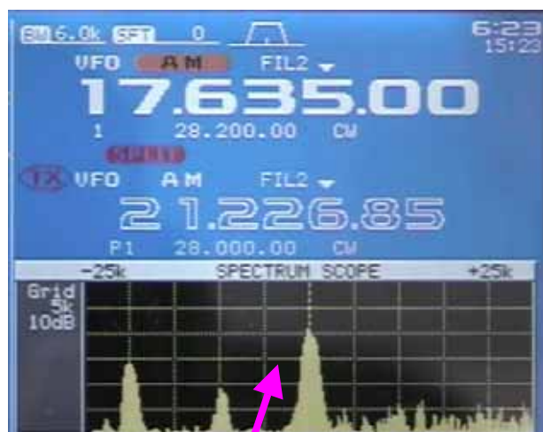
(1) PLC無接続状態
