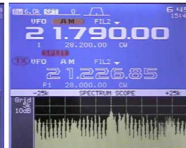
(3) PLC接続中 (ファイル転送中)
