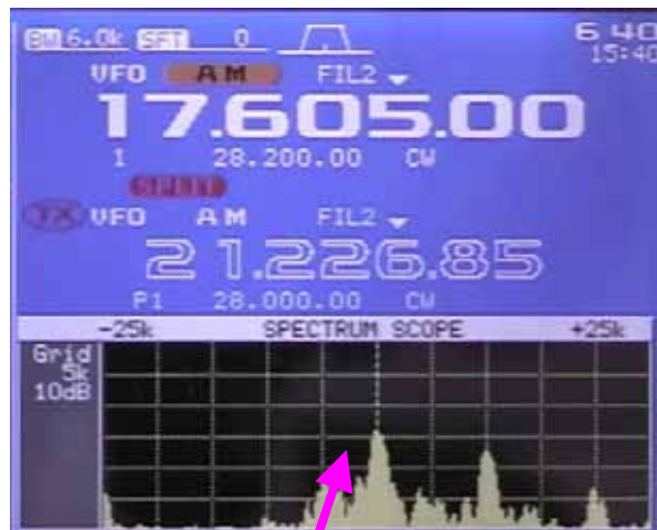
(1)PLC無接続状態
