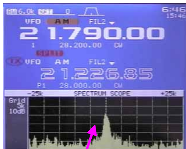
(1) PLC無接続状態
